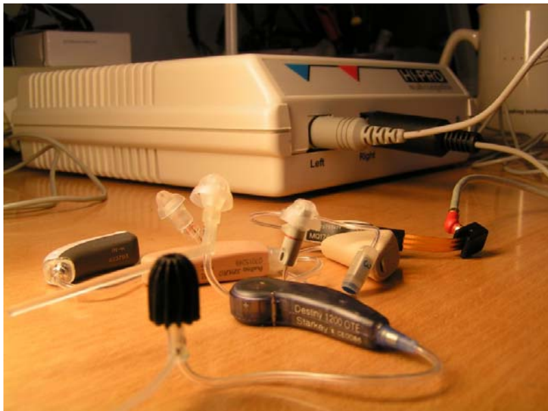
Et udvalg af åbent tilpassede høreapparater samt en HI-PRO boks til tilpasning af apparaterne.
