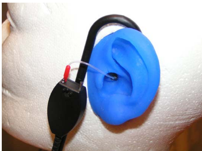
IG Måling: En objektiv måling til verificering af lydtrykket ved trommehinden efter en høreapparatilpasning.
