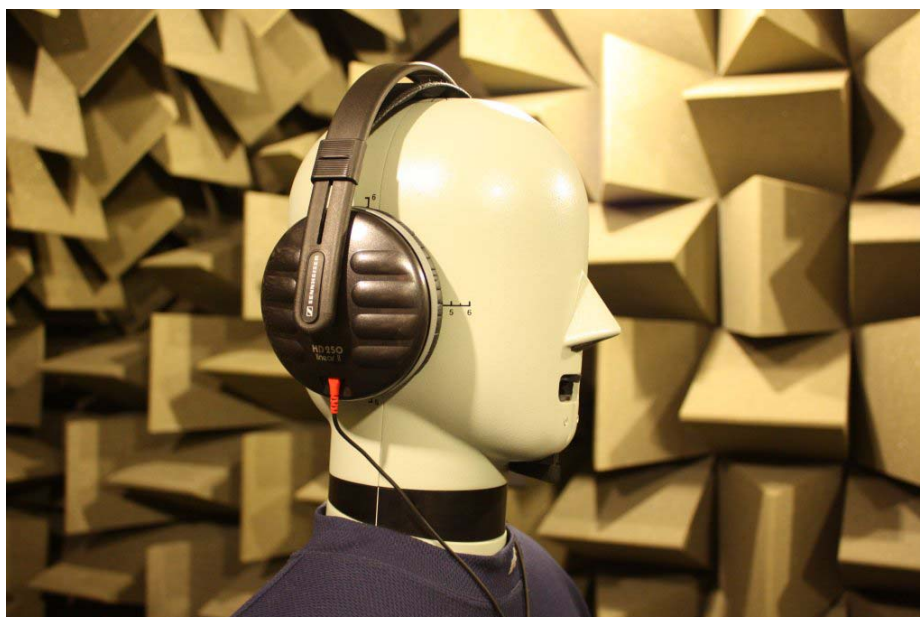
Head And Torso Simulator (HATS) med hovedtelefoner klar til at måle output fra en MP3 afsniller.
