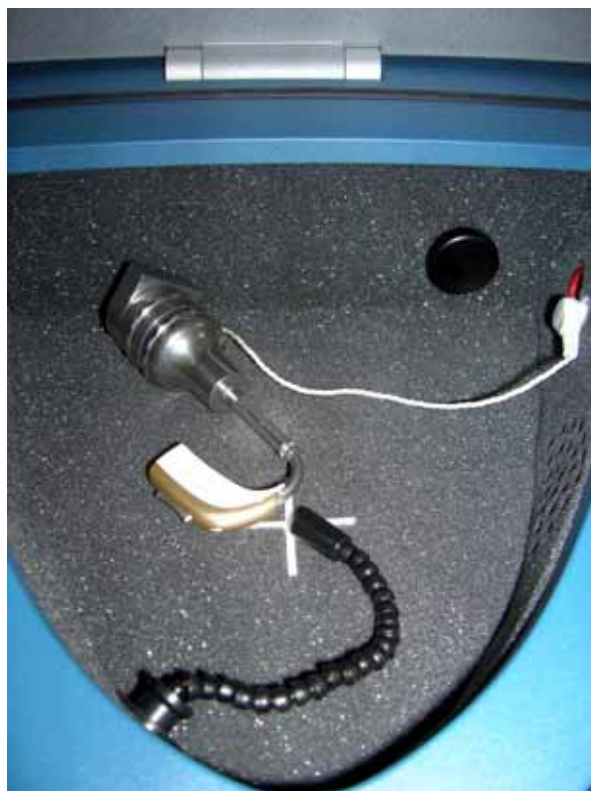
Figur 8.2 : Illustration af HA2 2cc coupler med høreapparat (Dillon, 2001, p. 77) Figur 8.3 : Høreapparat i Affinity 2.0
