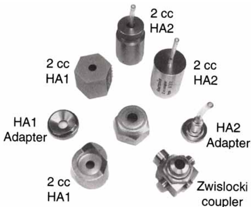
Figur 7.1 : Forskellige typer af couplere (Dillon, 2001, p.76)
