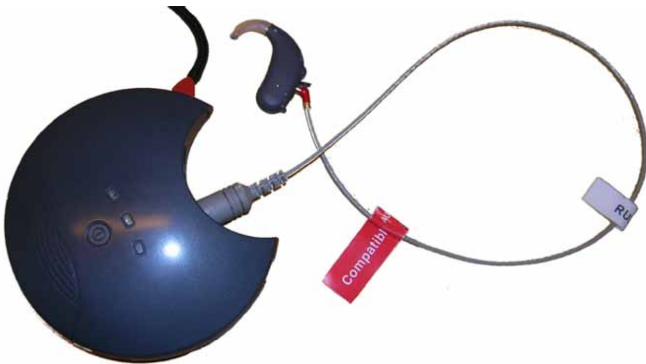
Figur 8.1 : Høreapparat forbundet til NOAH-link
