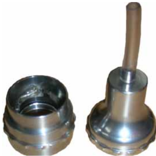
Figur 7.2 : 2cc coupleren der er brugt til forsøgene
